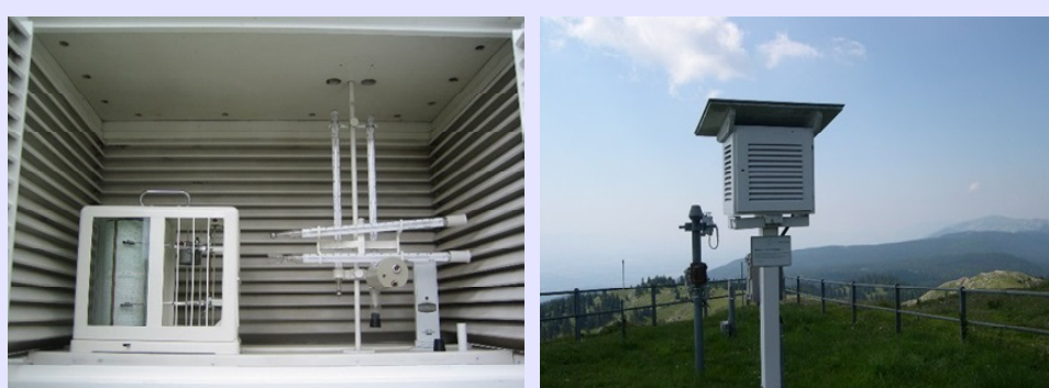
A la izquierda, interior de una garita meteorológica con psicrómetro, termómetro de máxima y mínima y termohigrógrafo.
