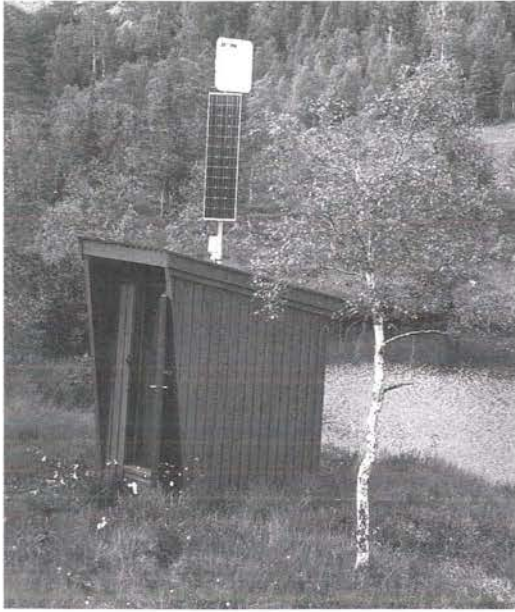
Figura 2 — Estación hidrométrica equipada con flotador, codificador óptico, registrador electrónico y panel fotovoltaico. La estación transmite los datos vía satélite. (Fotografía: Departamento de Hidrología de la NVE)
