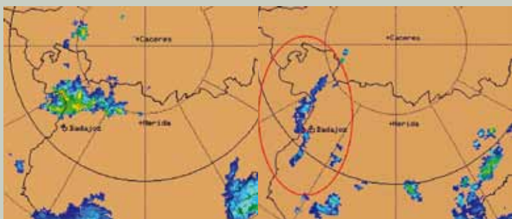
Figura 10. Imágenes PPI de reflectividad del 16 de junio. A la izquierda la correspondiente a las 20h10m Z incluye píxeles que alcanzaban los 58 dBZ. La imagen de la derecha es de las 22h00m Z, las mayores reflectividades no llegan a 30 dBZ; el punto rojo representa la EMA.
