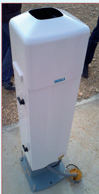
Ceilómetro CL31 para detectar altura de nubes
