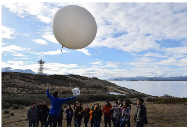
Figura 1. Observación de ozono en Ushuaia (Argentina). Las ozonosondas miden el ozono y otras variables meteorológicas a diferentes alturas a medida que la sonda asciende, hasta que el globo estalla (Fuente: Lino Condori).
