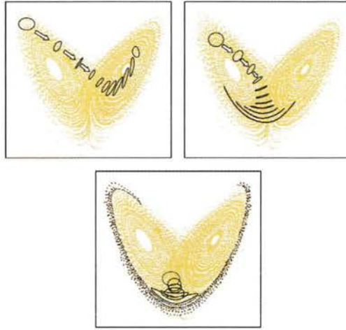
Figura 3 — La base científica de la predicción por conjuntos ilustrada utilizando el modelo prototipo de Lorenz (1963) del caos de orden bajo, que muestra que la predictibilidad de un sistema no lineal depende del flujo.
