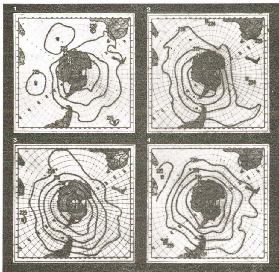
Figura 4.—Radiación emitida en la banda de 14 a 16 \mu y medida por el MRIR del «Nimbus II» en el hemisferio austral el 21 de mayo, el 10 de junio, el 11 y el 24 de julio de 1966. La intensidad de la radiación emitida viene dada en grados Kelvin del cuerpo negro que emitiría la misma cantidad de energía en esta banda espectral. La radiación medida ha sido emitida fundamentalmente por la parte baja de la estratosfera y, en esta región, es un buen indicador de la circulación general y del campo horizontal relativo de temperaturas.
