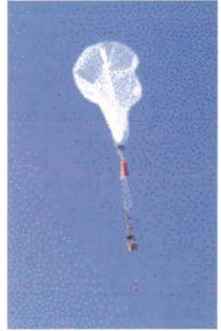
Figura 3 — (A la izquierda): esquema del sistema de radiosondas con paracaídas del NCAR. Está diseñado para volar en la baja estratosfera por encima de los niveles de la aviación comercial y desplegar radiosondas con paracaídas a petición en intervalos de 1 hora o mayores, (a la derecha) fotografía de una sonda a la deriva durante un vuelo de prueba sobre el oeste de Oregón. Tuvo lugar un exitoso vuelo de varios días.
