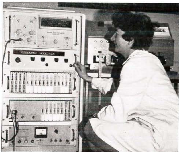
Comprobación de la unidad central de la instalación de telemetría numérica.
