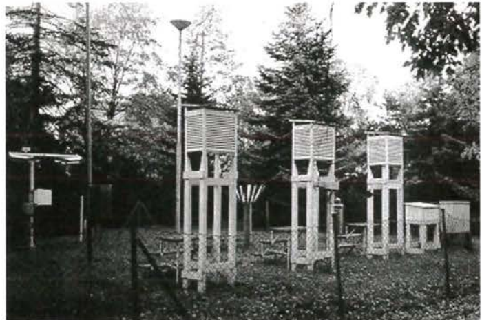
Figura 2 — Ejemplo de programa de observaciones paralelas en Helsinki, Finlandia. Dichos programas son necesarios cuando se producen cambios en los sistemas de observación o en la localización de las estaciones y hay que comparar los datos para garantizar que se mantiene la homogeneidad. (Fuente: Instituto Meteorológico Finlandés, Finlandia)
