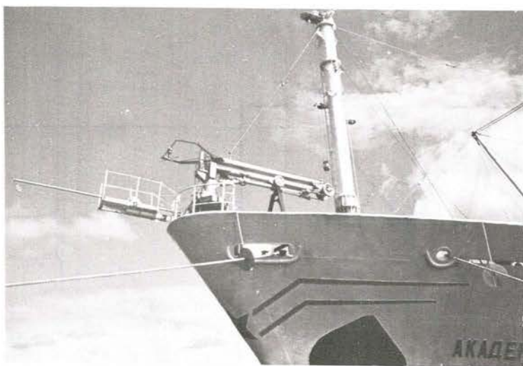
Equipo de medida de la turbulencia sobre la proa del RV Akademik Vernadsky .
