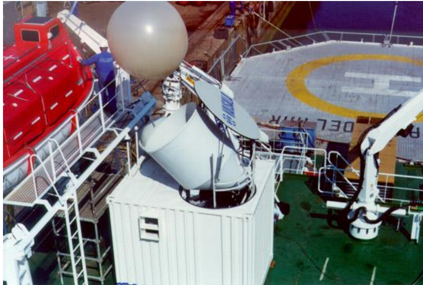
Figura 3: radiosondeo automático realizado desde el buque Esperanza del Mar.
