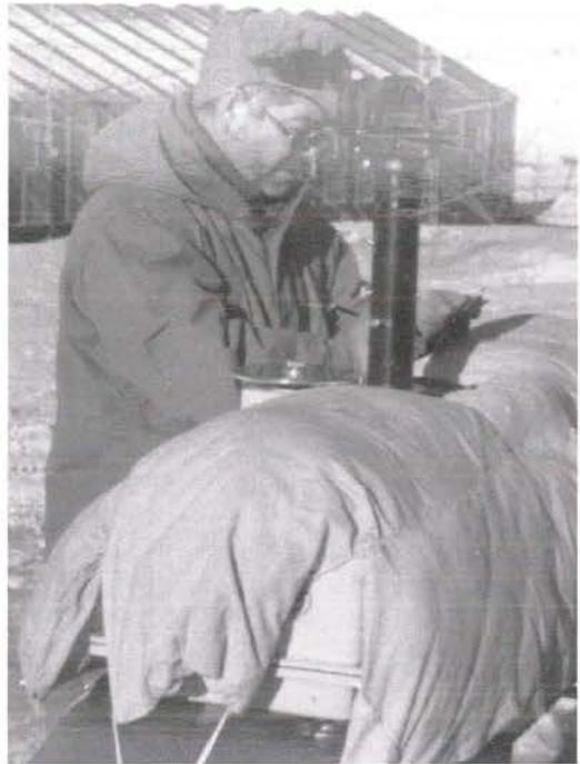
*Espectrofotómetro Dobson usado en la estación meteorológica argentina de la Antártida, Marambio, para medir valores de ozono.*
