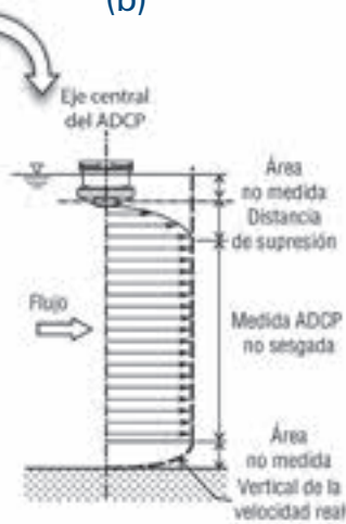
Figura 1 – Principio operativo de un perfilador de corriente de efecto Doppler (configuración Teledyne RDI ADCP): (a) disposición del haz; (b) resultado de la medición
