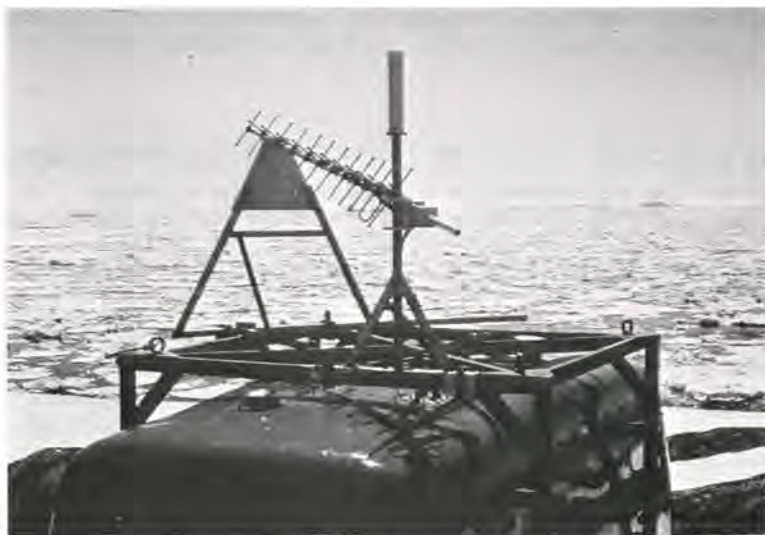
Las antenas del Argos y el METEOSAT sobre el techo de un remolque con una estación meteorológica automática en Ikermiuarssuk en la costa sudoriental de Groenlandia (Fotografía: Servicio Argos)
