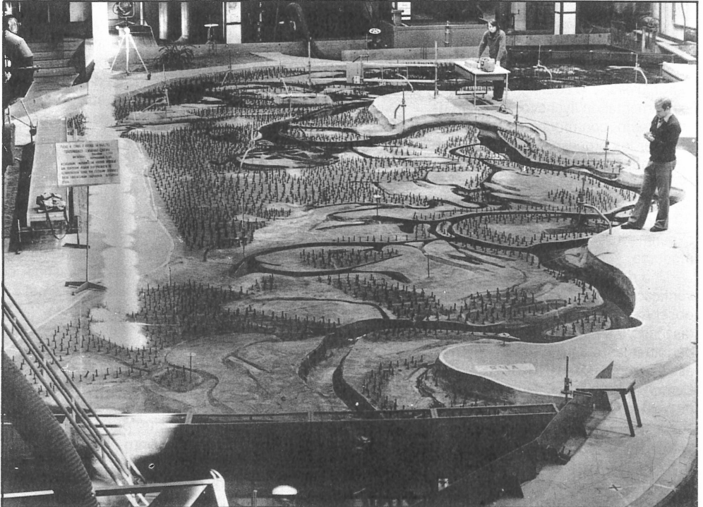
Figura 1 – Un modelo hidráulico de un complejo de canales de un río con meandros en la Base Experimental Principal del Instituto
