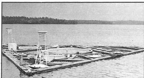
Figura 2 – Una plataforma flotante para medidas de la evaporación en el lago Valdai
