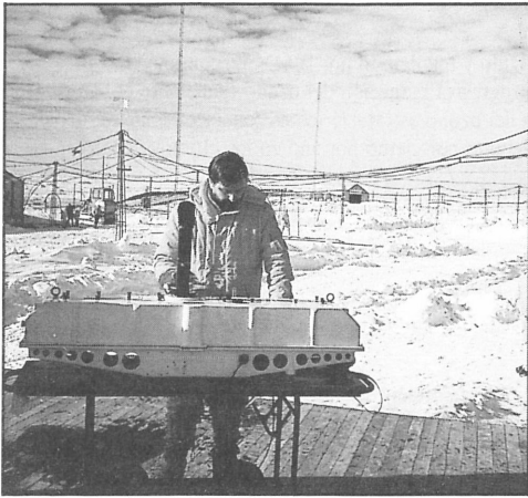
Espectrofotómetro Dobson para el ozono en la estación argentina 'Vicecomodoro Marambio', fuera de la Península antártica.
