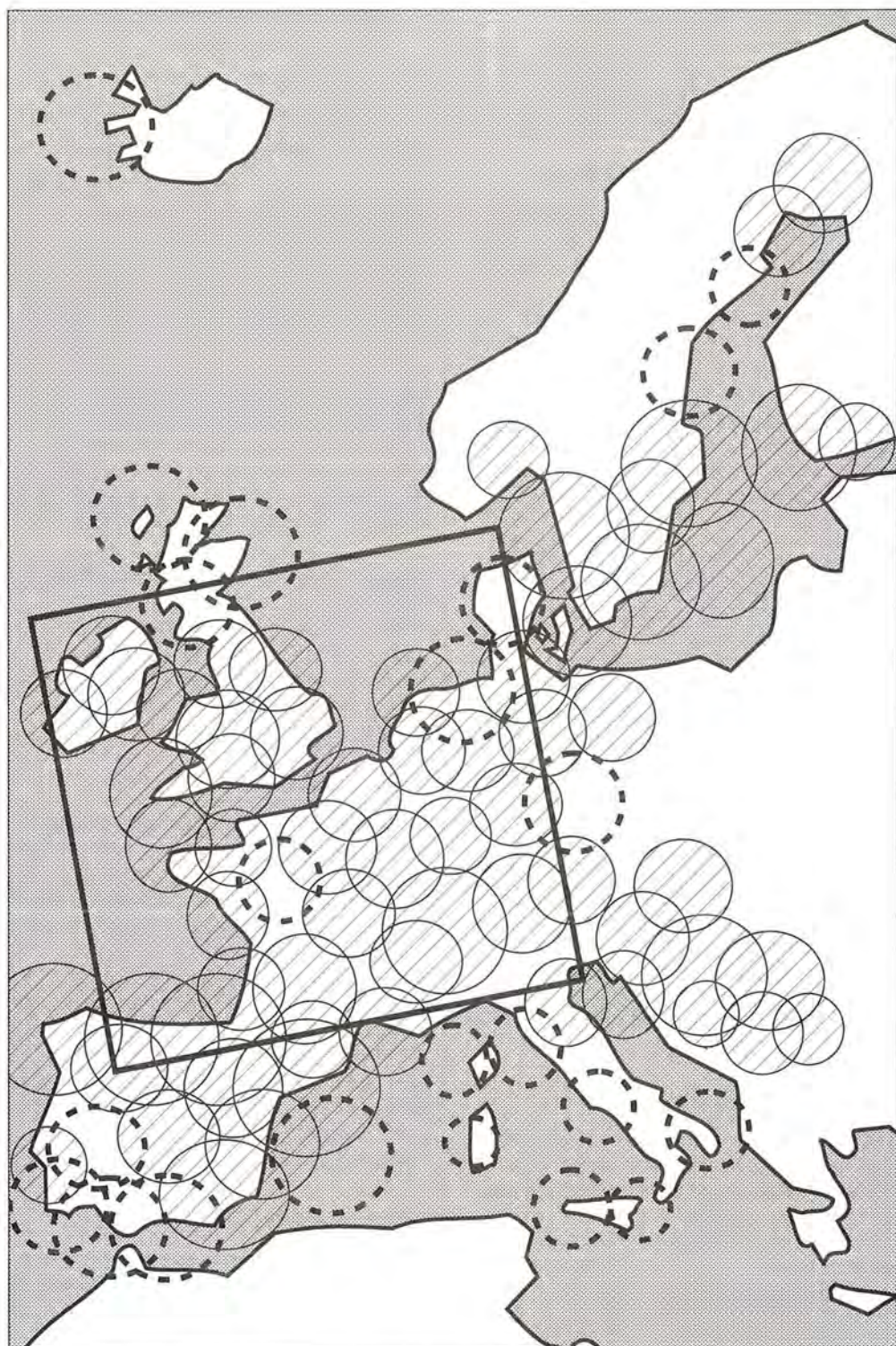
COST-73 — Proyecto de creación de redes de radares meteorológicos de la CCE; los círculos rayados indican la cobertura del haz del radar por debajo de los 1 500 m sobre el nivel del mar, tal como estaba en septiembre de 1991; los círculos en blanco indican la cobertura prevista.
