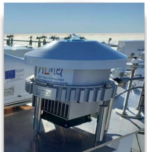
Fig. 5.6- Espectroradiómetro EKO MS-713
