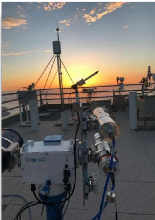
Fig. 6.2 - Atardecer desde la terraza de observación del Observatorio de Izaña durante la campaña EMPIR-MAPP. En primer plano aparecen los radiómetros PFR (Precision Filter Radiometer) y el espectrorradiómetro PSR (Precision Spec-troRadiometer) del World Radiometric Center, y al fondo se ven espectrómetros y radiómetros
