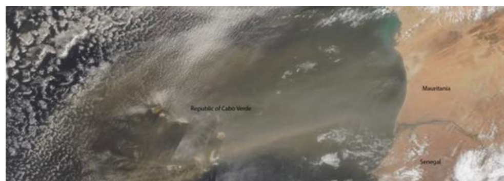
Fig. 6.5 - Intrusión de polvo. La imagen es una RGB natural calculada con los canales de SEVIRI (VIS0.6, NIRS.8 y NIRS.6) a bordo del Meteosat de Segunda Generación (MSG).
