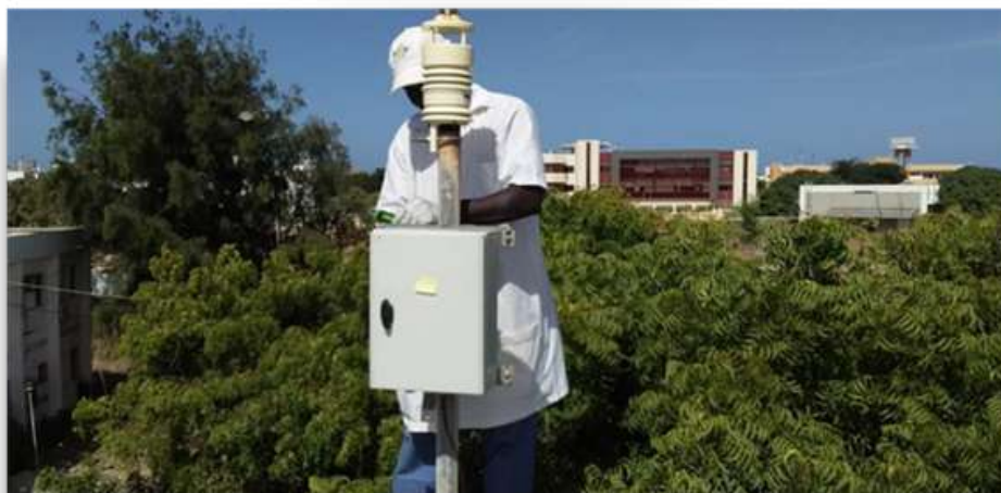
Fig. 6.6 – Sensor de material particulado instalado por el técnico de la Agencia Nacional de la Aviación Civil y la Meteorología de Senegal, como parte del proyecto MacClima.
