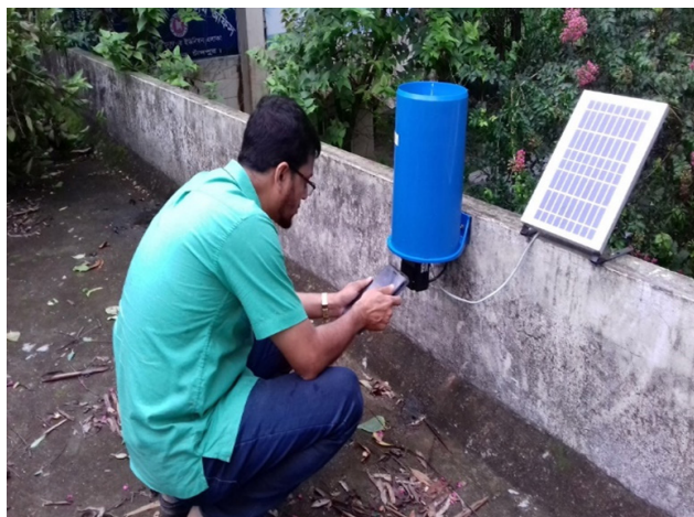
Registro de las precipitaciones mediante pluviómetros automáticos portátiles
