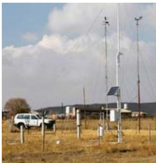
Figura 2: Reducción de las deficiencias de infraestructura estación por estación: se instala una estación meteorológica automatizada para mejorar las capacidades de observación y predicción. (Armenia's Weather Forecasting Revolution: Navigating Climate Challenges with Innovative Technology | United Nations Development Programme).
