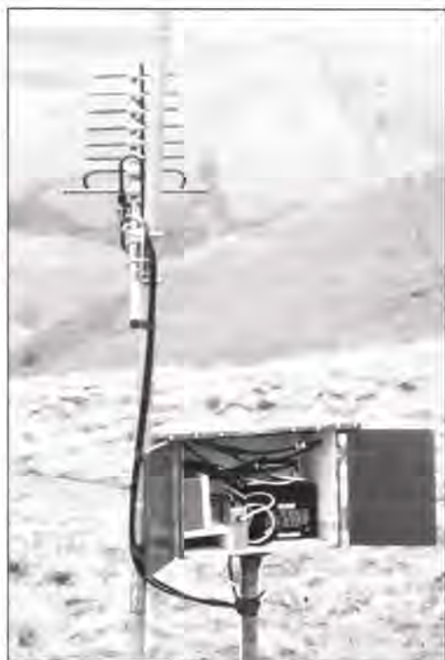
DCP de pluviometría en el centro de Gales, Reino Unido
