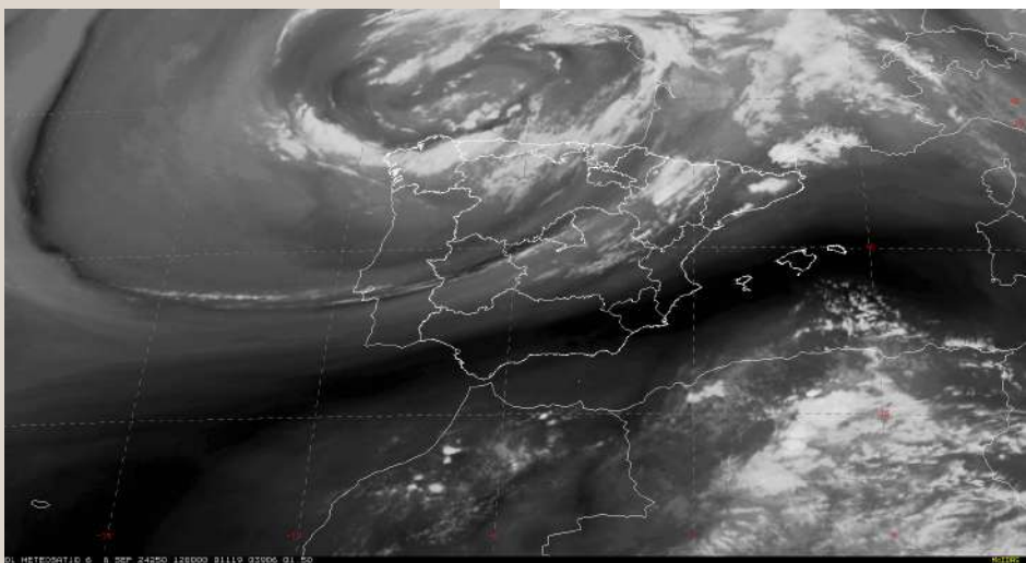
Figura 2. Imagen del canal vapor de agua 7.3 \mu\text{m} del Meteosat a las 12 UTC del 6 de septiembre de 2024. Se aprecia una banda seca asociada un máximo de viento en niveles medios cruzando la península ibérica, desarrollos convectivos en el nordeste y una banda nubosa asociada a la oclusión sobre Galicia.
