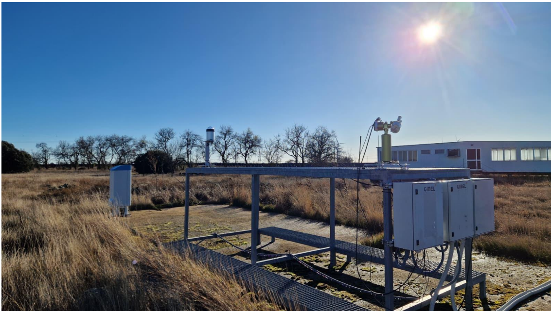
Figura 12. De izquierda a derecha: ceilómetro, cámara de todo cielo y fotómetro CIMEL instalados como equipamiento complementario en el CIBA.
