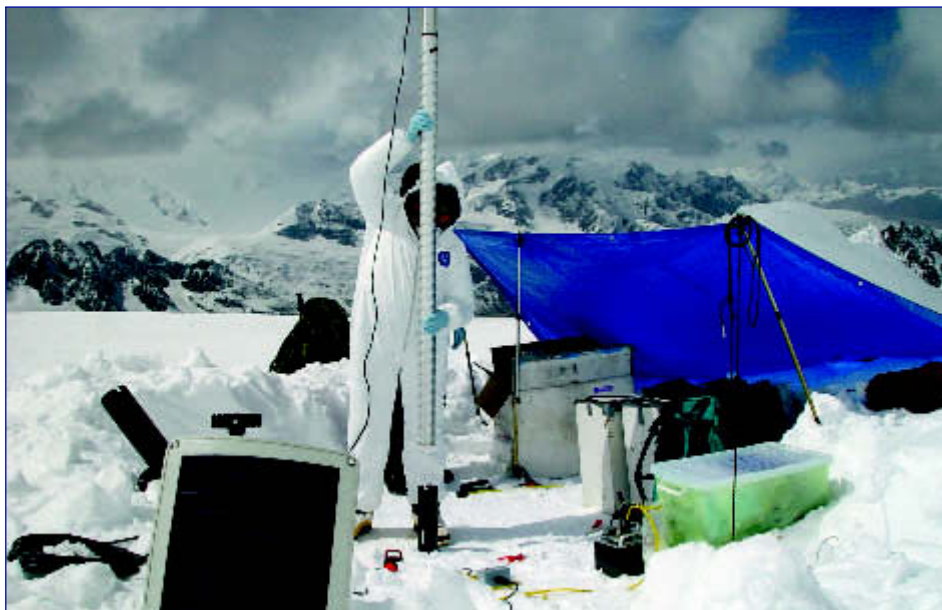
Figura 1 — Perforación de núcleos de hielo a 4 115 m, 49°N, en las Montañas de Altai (en la región sur de Siberia). La criosfera existe en todas las latitudes y hay una necesidad urgente de recoger núcleos de hielo de glaciares de altitudes altas y latitudes bajas antes de que el calentamiento destruya las señales climáticas que permanecen en el hielo frío (politérmico). (Fotografía: V. Aizen)
