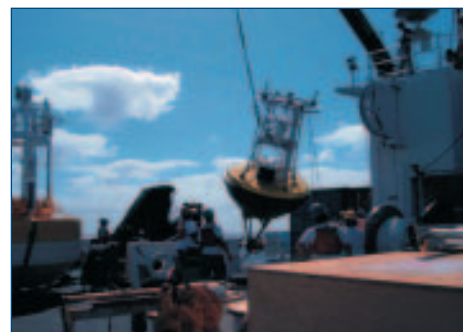
Figura 3 — Boya chilena de alerta de tsunamis desplegada desde el barco estadounidense de investigación Ronald H. Brown por un equipo conjunto chileno y estadounidense durante una misión climatológica para el mantenimiento anual de la estación oceánica de referencia "Stratus". También se desplegaron durante esta misión boyas a la deriva de superficie del GCBD y flotadores perfiladores de Argo.
