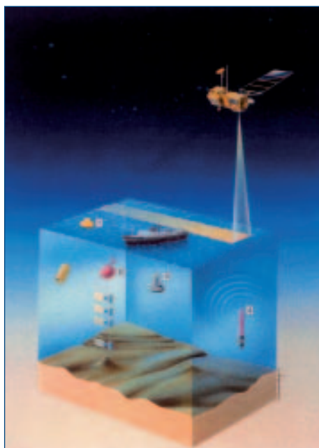
Figura 2 — Distintos tipos de datos oceánicos asimilados: (1) Boyas a la deriva; (2) dispositivos fijos; (3) medidas de barcos; (4) flotadores perfiladores verticales de ARGO. Las observaciones de teledetección son suministradas a través de satélite (véase el texto para ampliar detalles).
