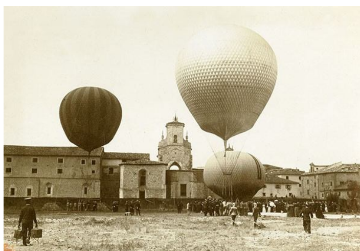
Fig. 29. Miembros de la compañía de aerostación inflando los globos aerostáticos, a través de las mangueras conectadas a los cilindros de hidrogeno comprimido. FO-25699. Fig. 30 y fig. 31. Dos fases del inflado del globo Júpiter. FO -5059 y FO -5064. Fig. 32. Los globos aerostáticos Júpiter y Marte ya inflados y el globo Urano terminándose de insuflar. Se puede observar la explanada de la huerta del Monasterio de San Juan y al fondo la espadaña del Monasterio de San Juan. FO-25702. Archivo del Ayuntamiento de Burgos.
