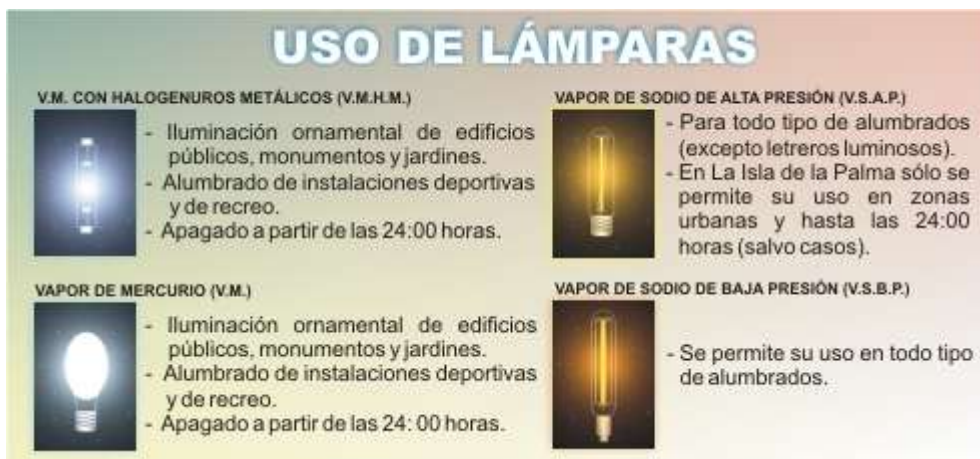
Figura 08: Lámparas de descarga más utilizadas en alumbrado exterior.
