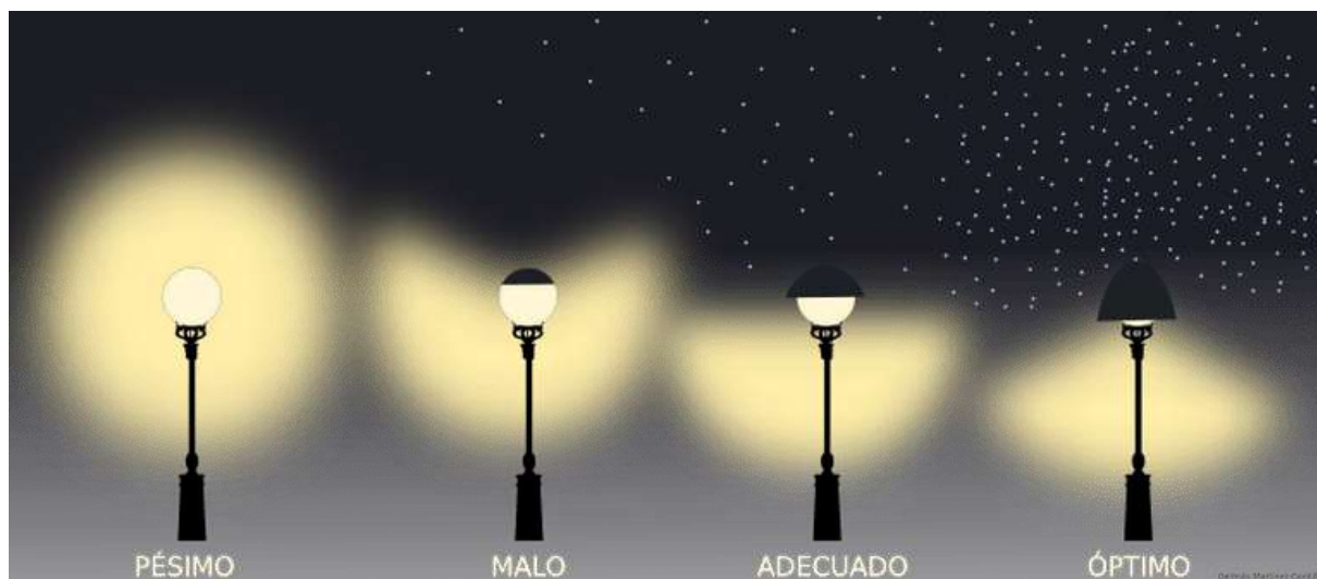
Figura 04: Inclinación y apantallamiento de las luminarias.
