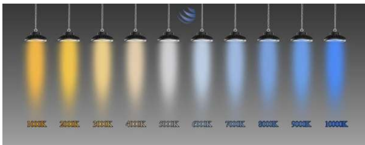
Figura 07: Temperaturas de color en iluminación LED, desde el anaranjado hasta el azul.
