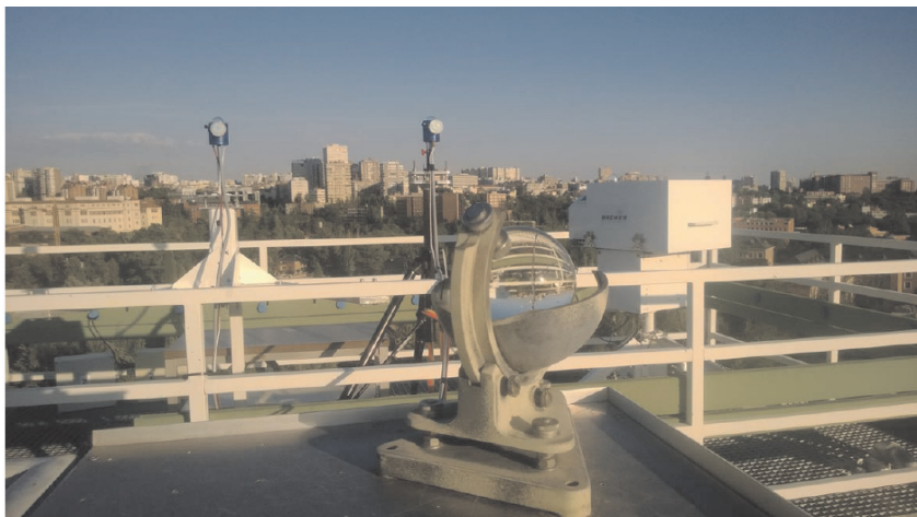
Calibración del espectrorradiómetro Bentham con el QASUME del WSG en el CRN.
