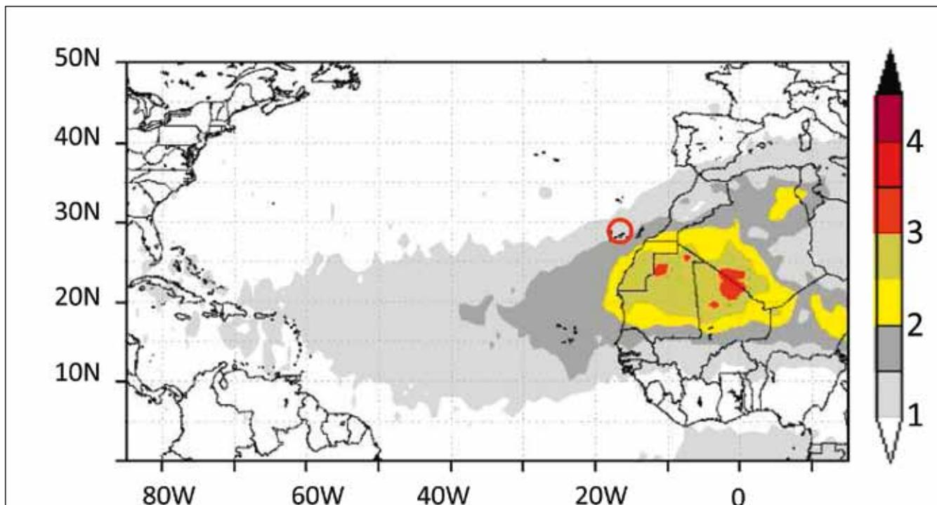
**Figura 1. Índice de Aerosol (unidades adimensionales) medio de Julio de 2008. Datos generados por el espectrómetro OMI (Ozone Monitor Instrument) a bordo del satélite Aura. Imagen obtenida mediante Giovanni Analysis Tool de NASA. Círculo rojo indica la ubicación de la estación de Vigilancia Atmosférica Global de Izaña (Tenerife).**
