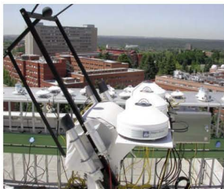
Diferentes equipos calibrándose frente a los patrones.
