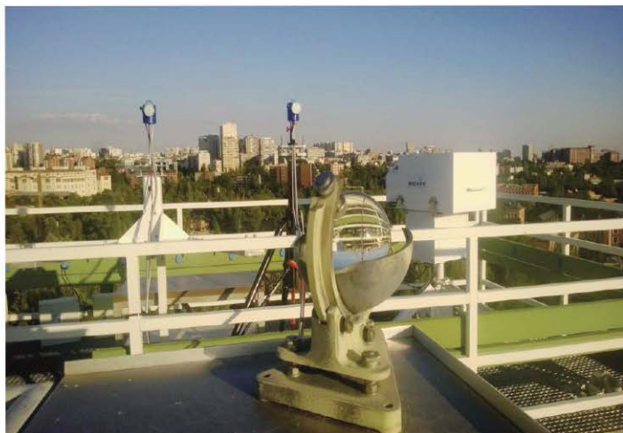
Calibración del espectrorradiómetro Bentham y del espectrofotómetro Brewer 186, con el QASUME del WSG en el CRN.
