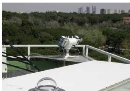
Dos pirheliómetros PMO6 instalados en el CRN durante la campaña de calibración.
