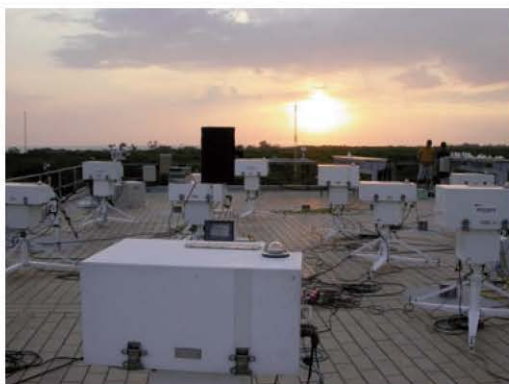
Intercomparación y calibración de espectrofotómetros Brewer en El Arenosillo en julio de 2013.
